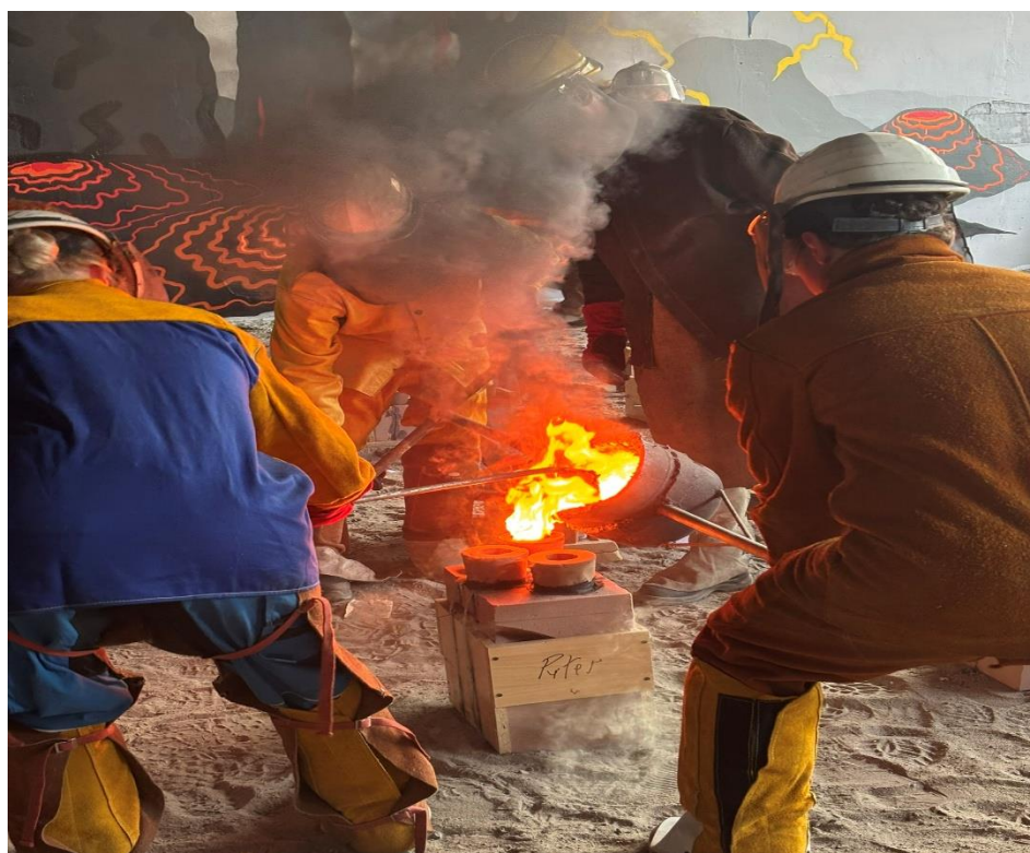
Zalievanie formy / Iron casting 2025, FVU AU zdroj: výročná správa FVU
